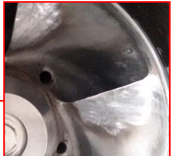
Laufrad nach der mechanischen Bearbeitung. Die Laufradschaufeln sind wiederhergestellt.
