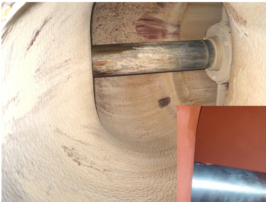
Druckgehäuse nach Reinigung / Bearbeitung und mit einer entsprechenden Rostschutzgrundierung versehen.
