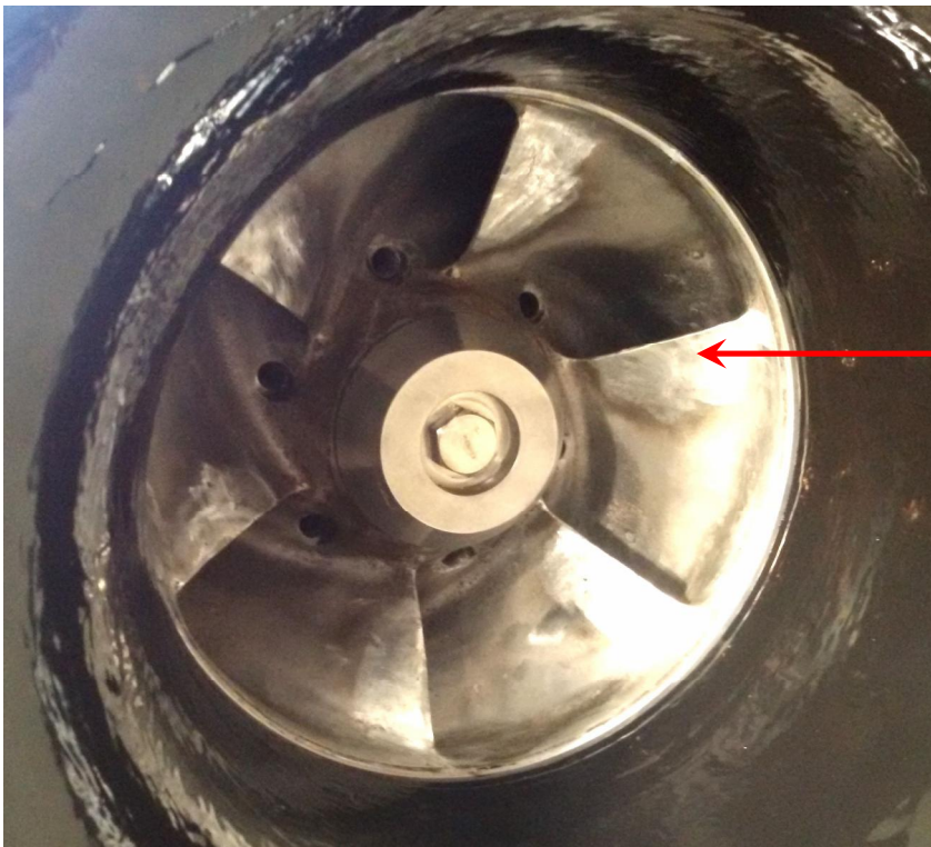
Laufrad nach der mechanischen Bearbeitung. Die Laufradschaufeln sind wiederhergestellt.
